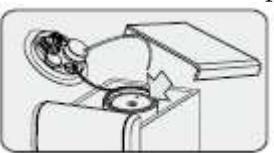
9. Перед использованием, чтобы прополоскать гидравлическую систему аппарата, слейте из обоих кранов по 5-6 литров воды (поочерёдно нажимая на клавиши подачи горячей и холодной воды).
