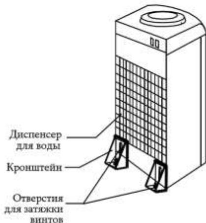
Примечание: при перемещении или чистке диспенсера извлекайте винты, которыми крепится устройство.
